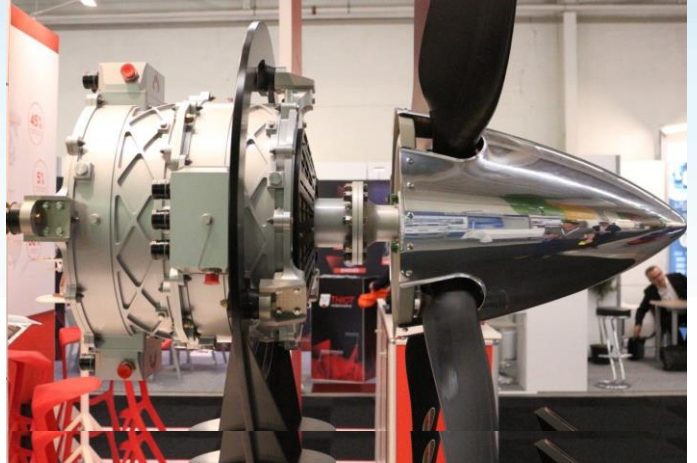
magniX出品的750-hp电动引擎
